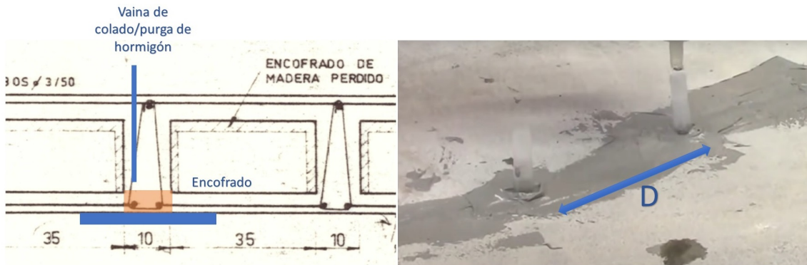
Figura 7: Método de relleno de hormigón interior accediendo desde el exterior. La zona destacada en naranja es la que se reparará.
